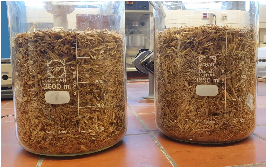
Abb. 6: Reine Schüttung aus Typha-Mischung (Norddeutschland) ; Rohdichte ca. 65 kg/m 3
